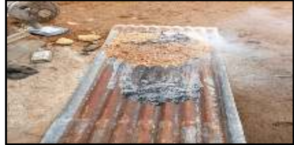
Gambar 1 dan 2 : Pembakaran Sampah Untuk Membuat Briket Arang (Pengarangan)
